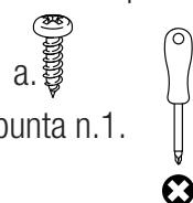
Utensile da utilizzare (non fornito): cacciavite per vite con testa a croce, con punta n.1.
