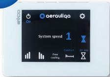
Pannello di controllo con display grafico touch-screen, a colori, 3,5", multifunzione, per la gestione del sistema di ventilazione decentralizzato composto da unità ORION 100 e 150. Può controllare via Modbus sino ad 8 unità.
