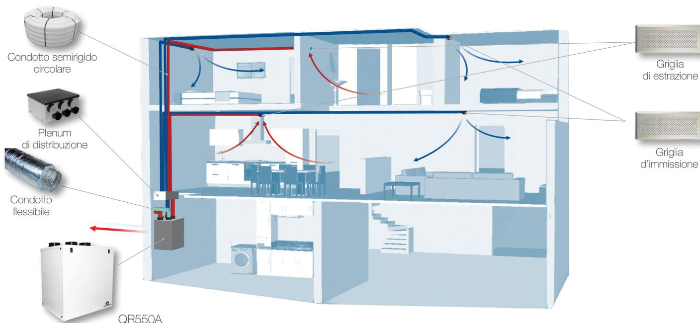
**Caratteristiche di sistema:** unità VMC centralizzata (QR550A) a doppio flusso provvista di recuperatore di calore che permette di trasferire il calore dell'aria estratta dagli ambienti interni all'aria fresca immessa dall'esterno, con il massimo comfort acustico. E' necessario prevedere un adeguato sistema di distribuzione dell'aria in modo che ogni singolo ambiente interno sia ventilato opportunamente.
